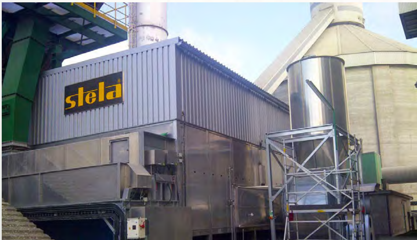
项目地：Lafarge, 波兰 | 型号：BT 1/2700-10 | 安装年份：2014 干燥物料：SSW固废垃圾 | 出料能力：约10.0吨/小时 | 降水区间：35% - 10%湿度
