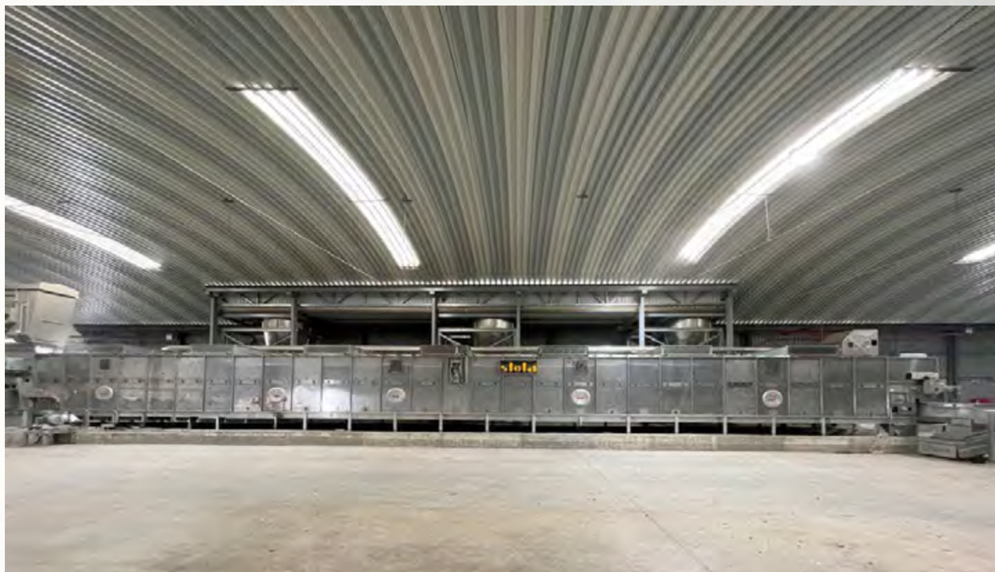
项目地：Bianna Recycling Poj. Ambilital, 葡萄牙 | 型号：BTL 1/3000-28 | 安装年份：2022 干燥物料：RDF垃圾燃料 | 出料能力：约4.6吨/小时 | 降水区间：48% - 14%湿度
