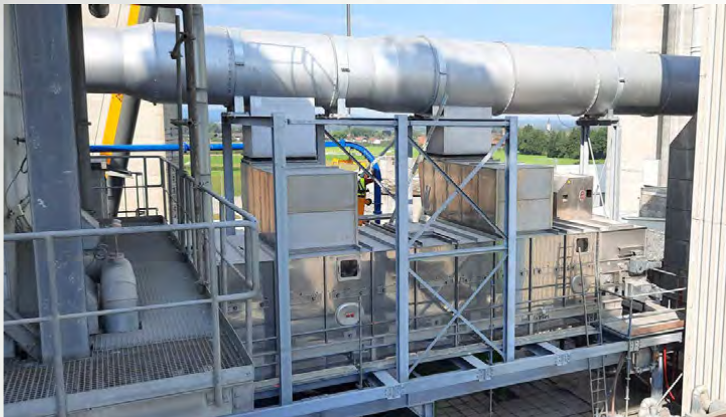
项目地：Südbayerisches Portland Zementwerk, 德国 | 型号：BTL 1/3000-20 | 安装年份：2021 干燥物料：RDF垃圾燃料 | 出料能力：约10.4吨/小时 | 降水区间：18% - 5%湿度
