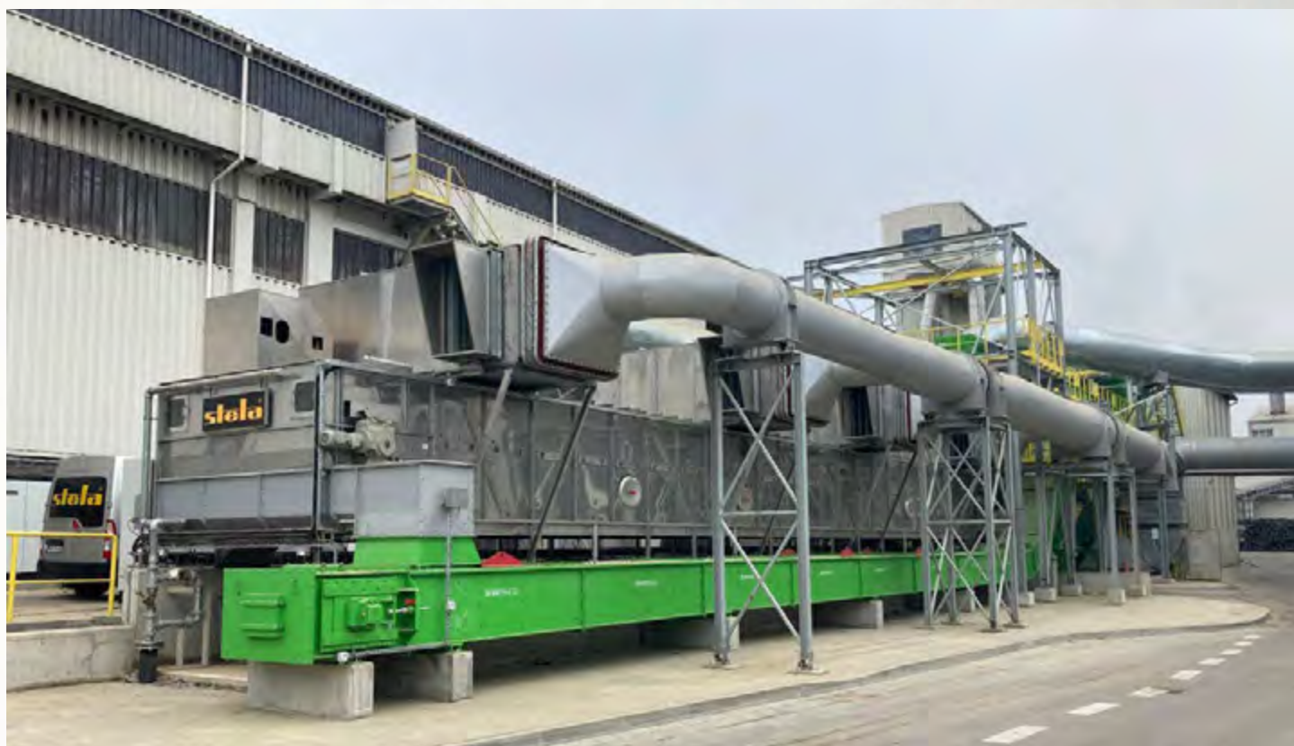
项目地：Dyckerhof Polska, 波兰 | 型号：BTL 1/3000-22 | 安装年份：2023 干燥物料：RDF垃圾燃料 | 出料能力：约23.0吨/小时 | 降水区间：19% - 10%湿度
