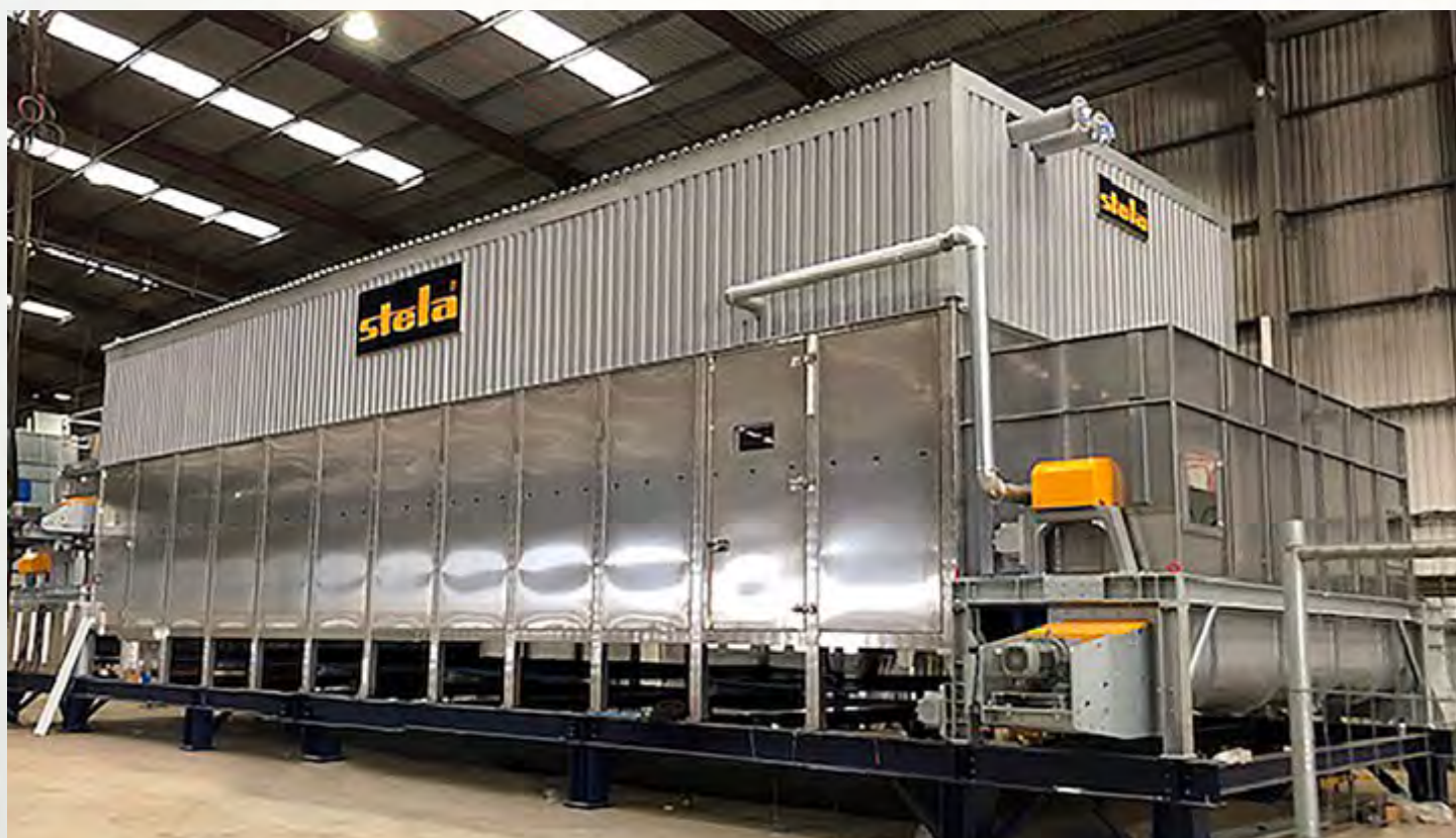
项目地：Subcoal Production, 英国 | 型号：BT 1/6200-18 | 安装年份：2019 干燥物料：RDF垃圾燃料 | 出料能力：约19.0吨/小时 | 降水区间：25% - 10%湿度
