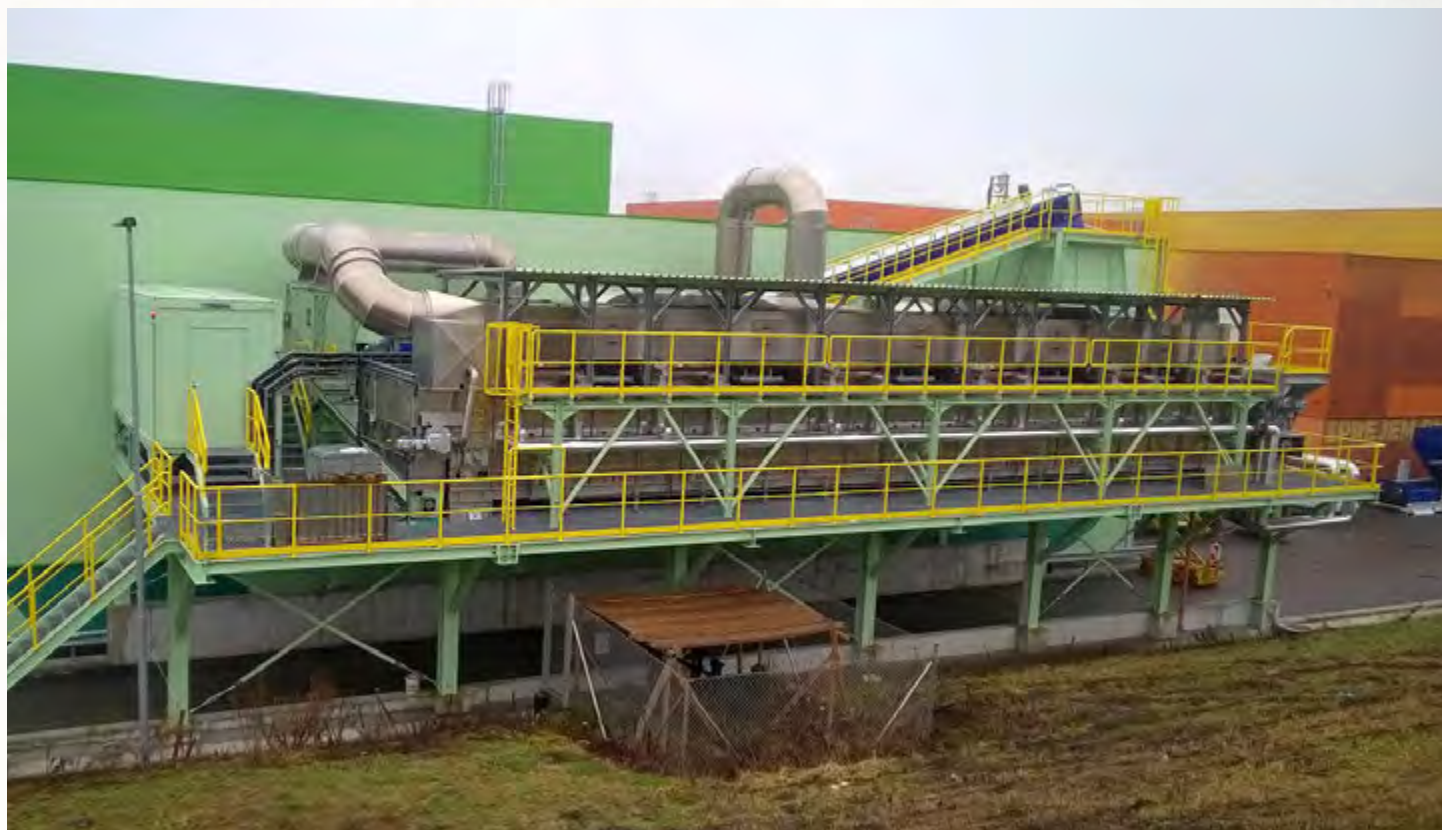
项目地：Strabag，斯洛文尼亚 | 型号：BTLU 1/3000-54 | 安装年份：2018 干燥物料：MSW城市固废 | 出料能力：约7.0吨/小时 | 降水区间：28% - 15%湿度
